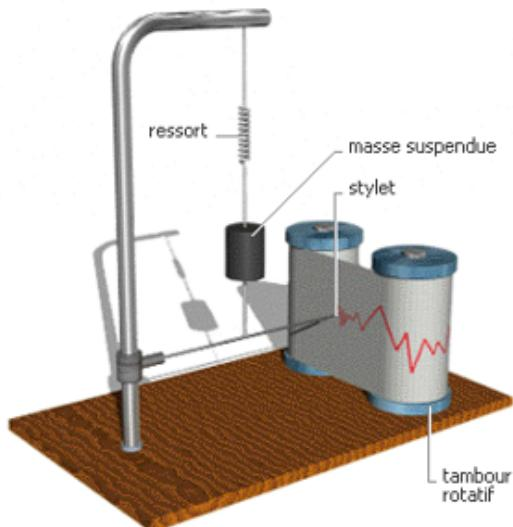
Le sismographe présenté ici permet de détecter et d'enregistrer les mouvements d'ondes verticales. Lorsqu'une onde sismique atteint le sismographe, le sol, le cadre et le tambour rotatif vibrent en oscillant verticalement, alors que la masse suspendue par le ressort reste immobile du fait de son inertie. Le stylet relié à la masse trace ainsi une ligne brisée sur le tambour.
