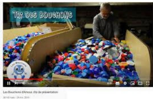
Puis les bouchons sont recyclés. Une usine rachète les bouchons (les fonds sont reversés à l'association), les bouchons sont broyés puis ils ajoutent des additifs et mélangent tout puis ce mélange chauffe dans une cuve à 90° puis passent dans une cuve à 250°. Une fois le plastique liquide, il est moulé pour faire des palettes en plastique. L'association se sert des fonds récolter pour les clubs handisports et pour acheter des chiens d'accompagnement
