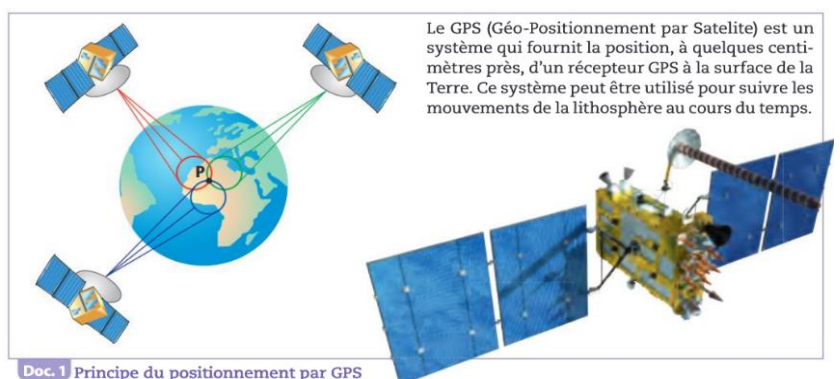
Doc. 1 Principe du positionnement par GPS
